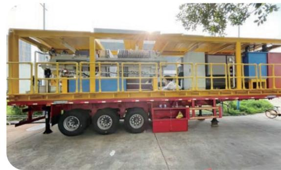
华润环保开发污泥处理移动干化车，实现污泥脱水模块化、集成化、机动化
