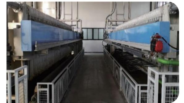
华润环保采用“MCP微波调理+板框压滤”污泥深度脱水技术，常温下实现将97%含水率污泥脱水至40%-50%
