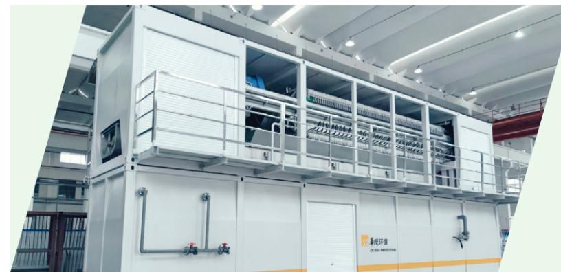
模块化调理 + 板框压滤成套技术及撬装式设备
